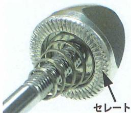
アルミ製のクイックではナット側のセレート (ギザ) がつぶれてしまうことがあります。
