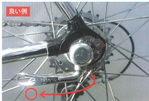
クイックレバーの方向が上向きになるようにレバーを最後まで強く押し込む。
