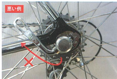
クイックレバーがフレームに干渉しているとレバーを最後まで締め込めない。
